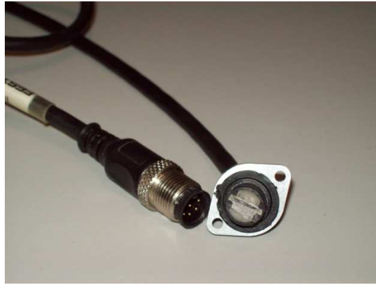
Fig. 2.30. Sensor dañado del cilindro DNCI
