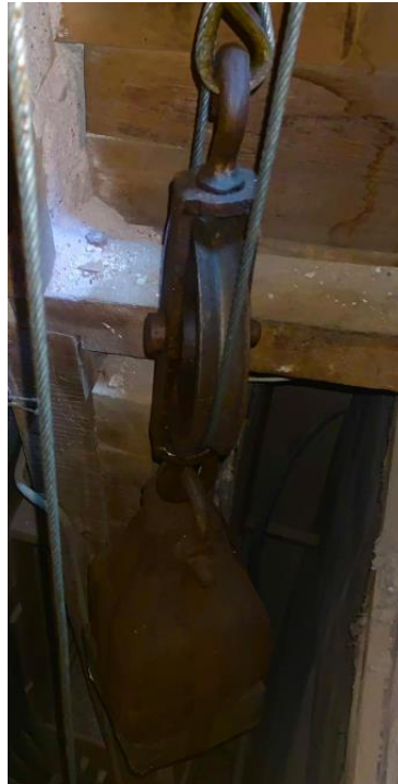
Figura 3. Sistema de contrapesos del reloj de las económicas.
