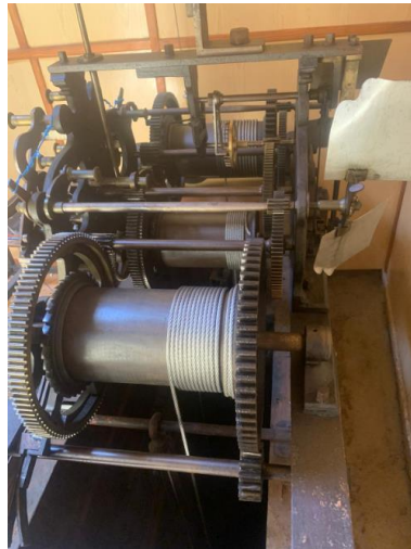
Figura 7. Mecanismo del reloj de las económicas.
