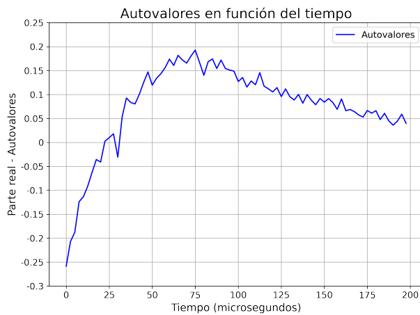
Figura 35: Representación de la parte real de los autovalores en cada instante de la evolución en el proceso “Quantum State Tomography”. En el eje de ordenadas (eje y) se representa la parte real de los autovalores. En el eje de abscisas (eje x) se representa la evolución temporal de estos.
