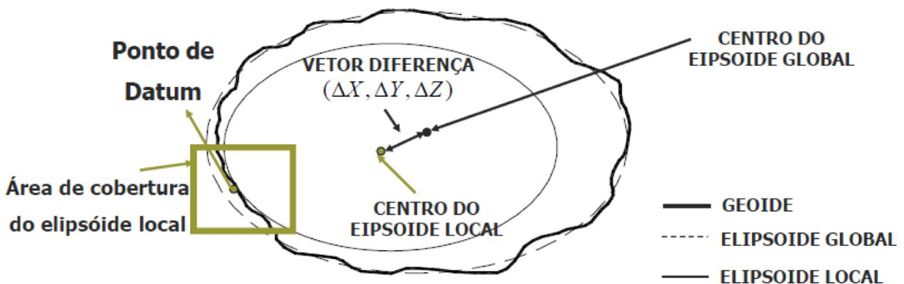
Figura 2 Comparación entre elipsoide global y elipsoide local. Fuente: tiagomarin.com. (Instituto de Agronomía UFRRJ)
