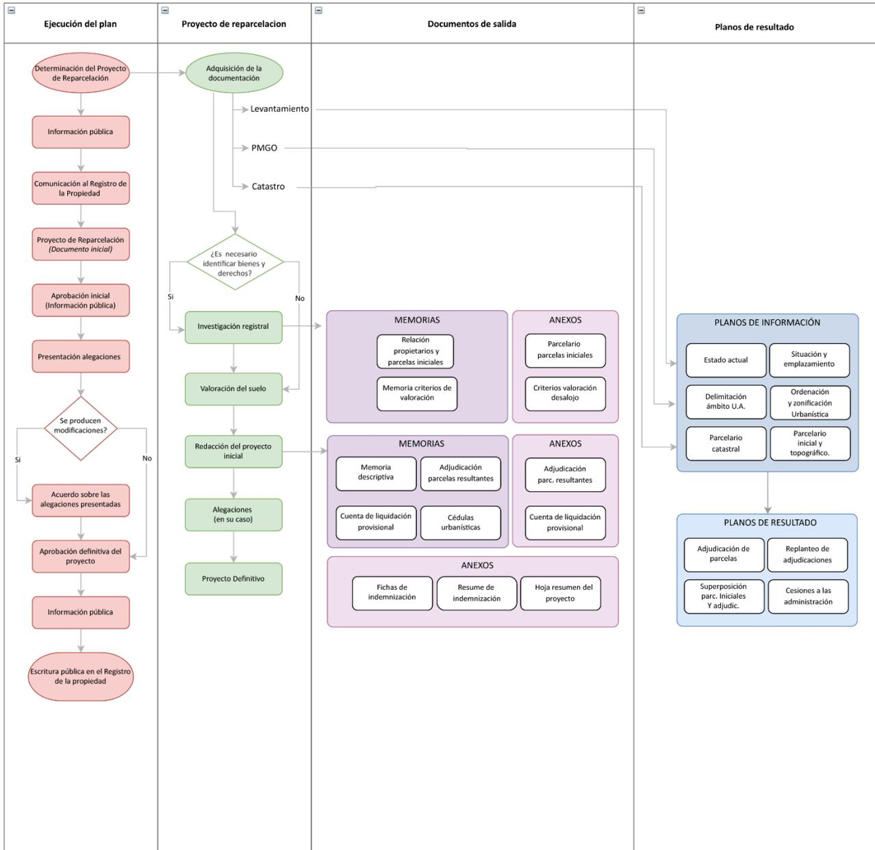
Figura 10 Proyecto de reparcelación según el procedimiento convencional
