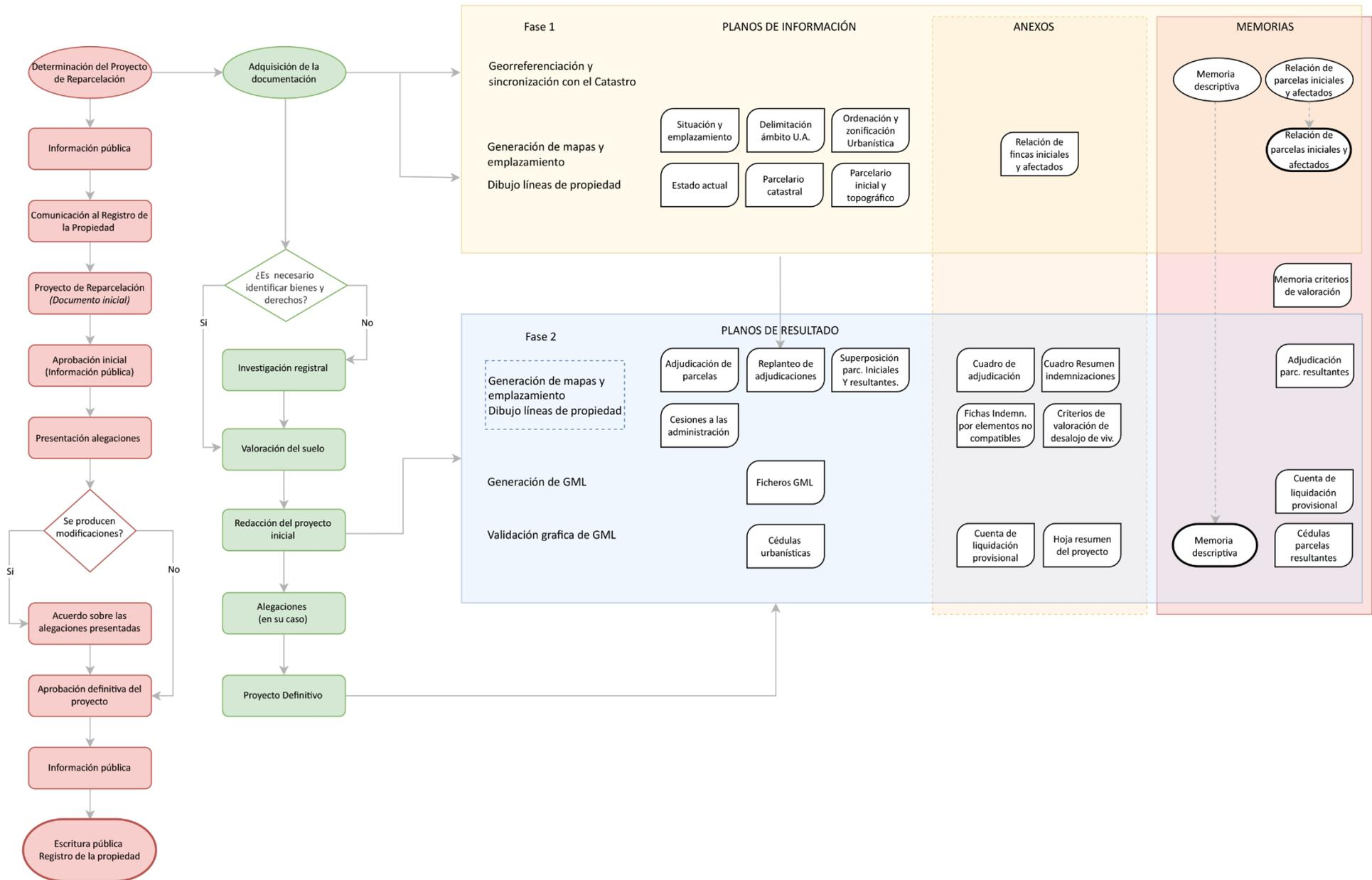
Figura 41 Proyecto de reparcelación según el nuevo procedimiento en BIM
