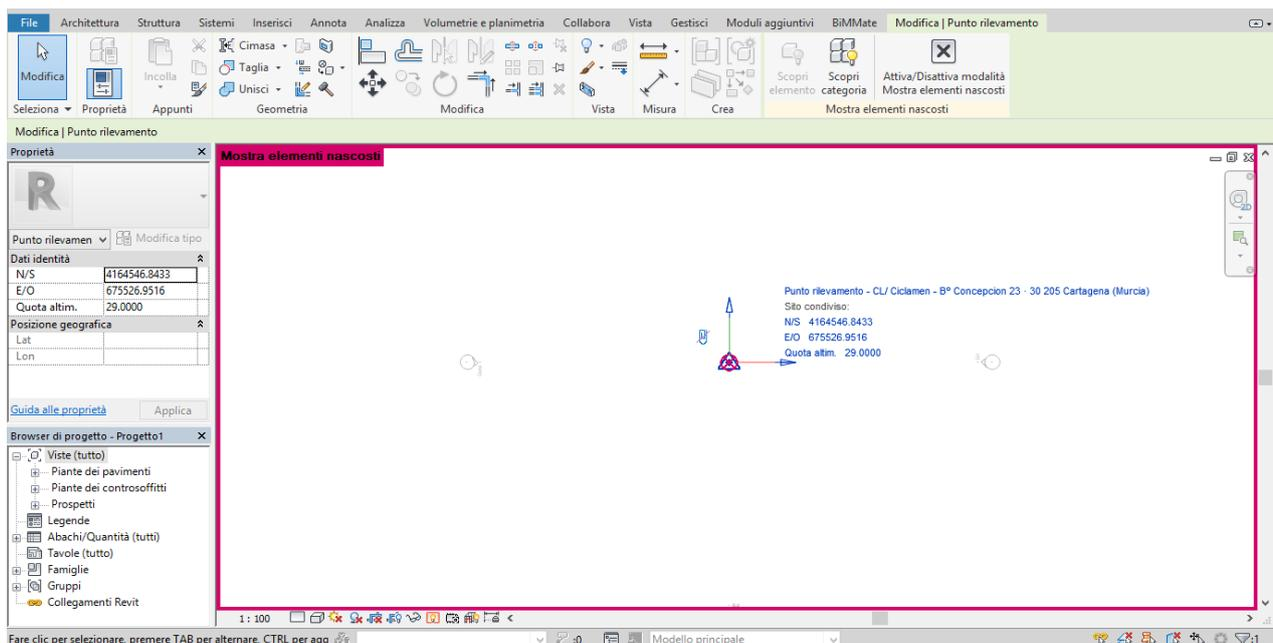
Figura 27 Proyecto georreferenciado en Revit- BimMate
