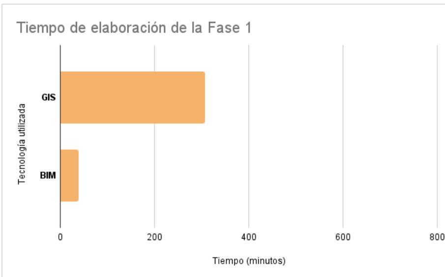
Figura 43 Tiempo de elaboración de la Fase 1. Comparación GIS y BIM
