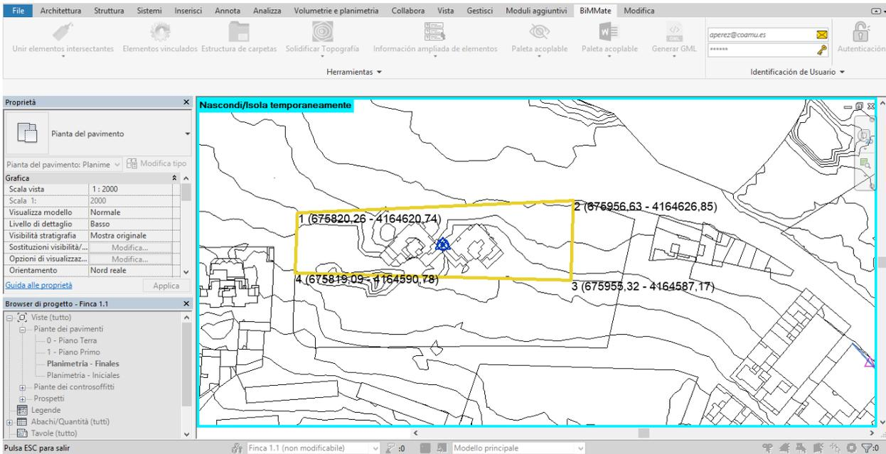
Figura 34 Introducción de los puntos de coordenadas
