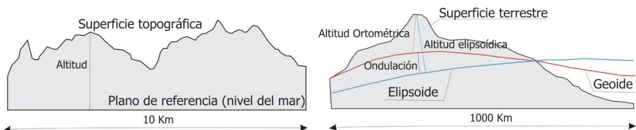
Figura 1 Representación geoide y elipsoide. Fuente: [coello.ujaen.es/asignaturas/cartografia](http://coello.ujaen.es/asignaturas/cartografia). (Universidad de Jaén)
