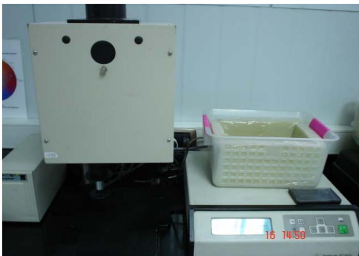
**Figura 3.** Colorímetro Hunter Lab, usado para medir color.
