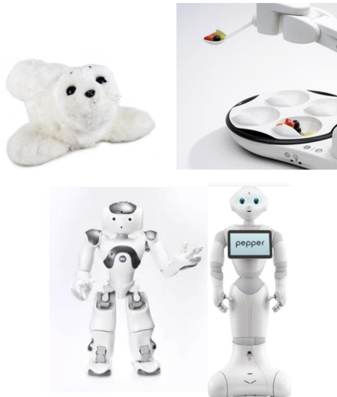
Figura 2.7. De izquierda a derecha y de arriba abajo: Robot Paro, Robot Nao, My Spoon y Pepper.
