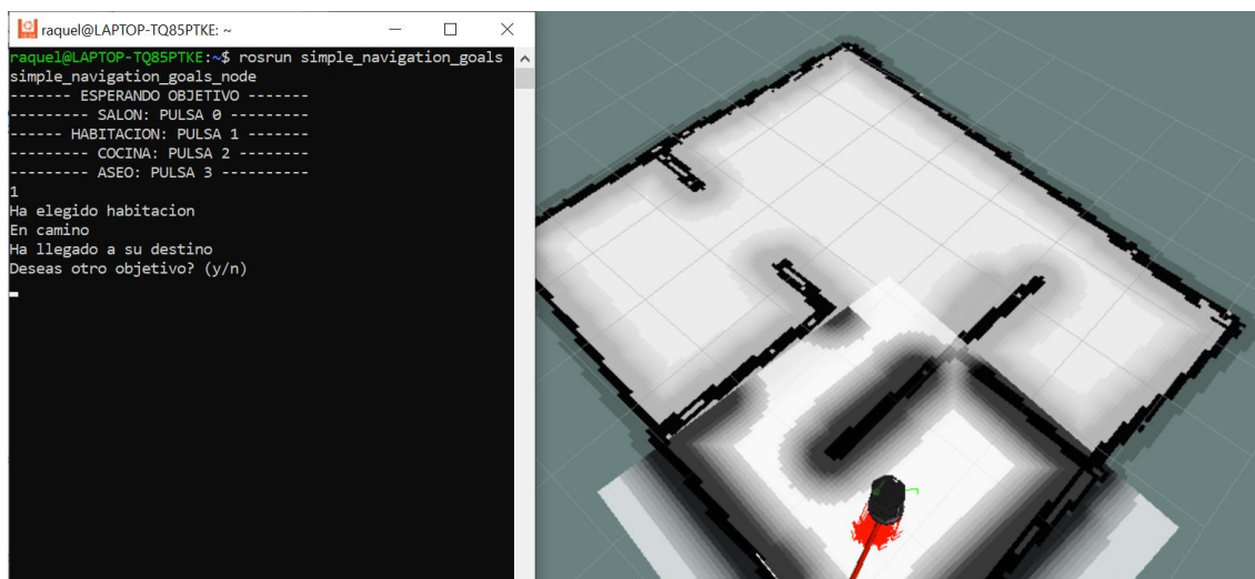
Figura 6.33. Salida por pantalla del nodo simple_navigation_goals_node después de llegar a su objetivo.
