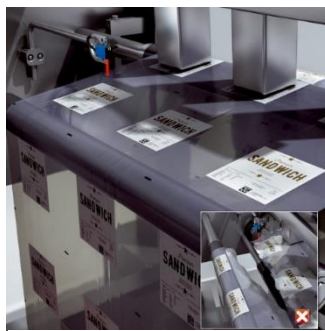
Figura 7. Rotura de láminas transparentes
