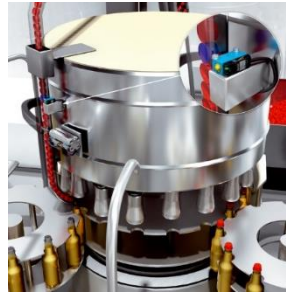
Figura 12. Clasificación de tapones con sensor de color
