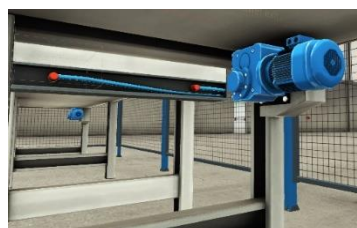
Figura 15. Actuadores de Buffer Station
