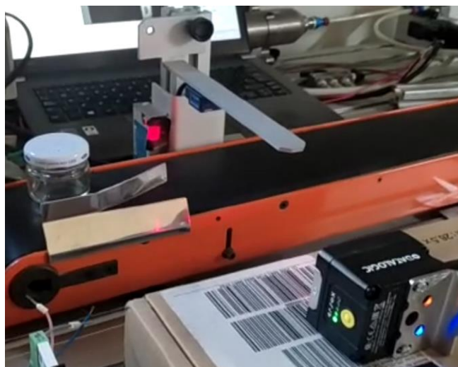
Figura 128. Instalación práctica provisional de sensor de visión en cinta transportadora
