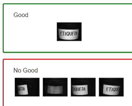
Figura 137. Casos buenos/malos de orientación de etiqueta
