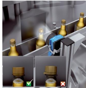
Figura 9. Comprobación de calidad de tapones con sensor de visión 2D
