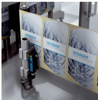
Figura 5. Detección de etiquetas opacas
