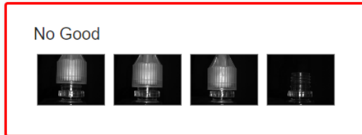
Figura 6. Roscado y presencia de tapón
