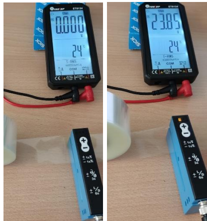
Figura 121. Funcionamiento de sensor de horquilla de ultrasonidos con etiquetas transparentes
