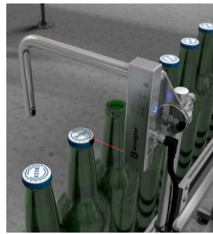
Figura 2. Presencia de tapones
