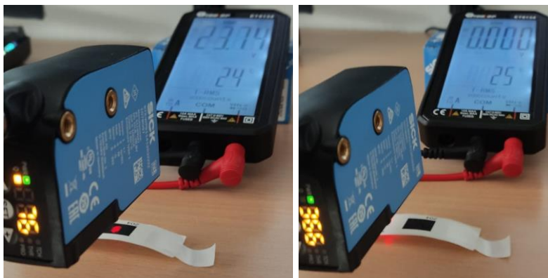
Figura 124. Funcionamiento de sensor de contraste con máculas de etiquetas
