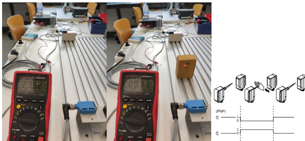
Figura 113. Funcionamiento de fotocélula de barrera emisor-receptor
