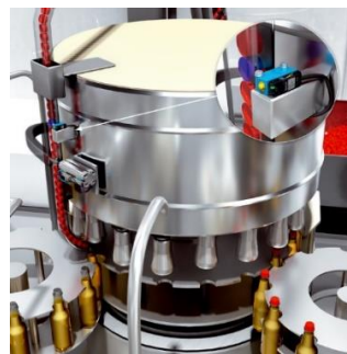
Figura 5. Detección de color de tapones
