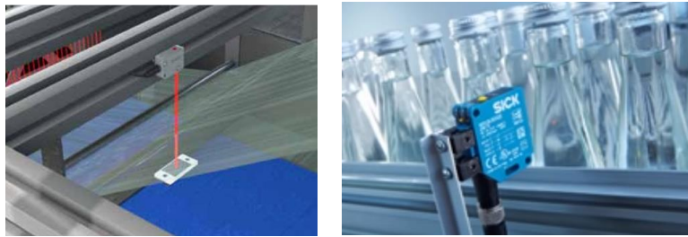
Figura 9. Aplicaciones típicas de fotocélula de espejo para objetos transparentes
