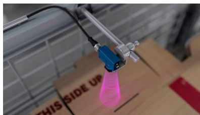
Figura 19. Ultrasonidos en Buffer Station
