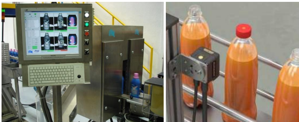
Figura 25. Control de calidad de etiquetado
