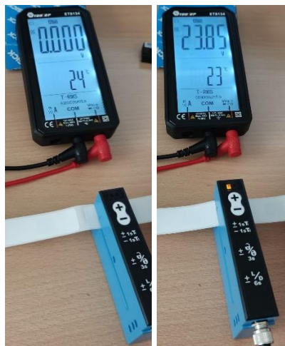
Figura 122. Sensor de horquilla de ultrasonidos con etiquetas opacas
