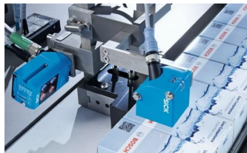
Figura 8. Control de seguridad en medicamentos con sensor de brillo
