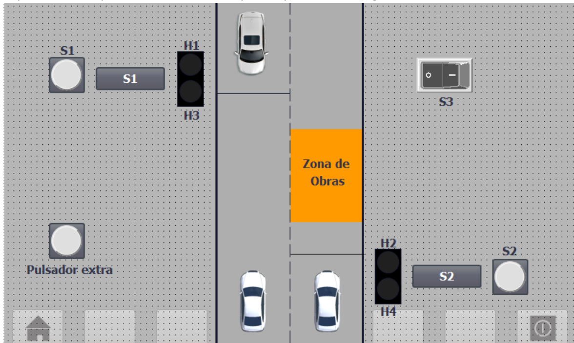
Figura 79. Representación del semáforo de obra en el HMI
