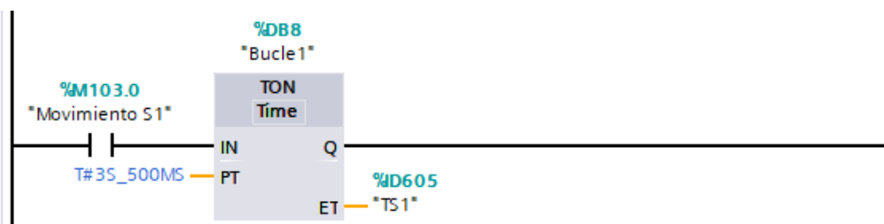
Figura 80. Temporizador del que depende el movimiento
