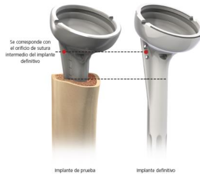
Figura 53. Ajuste de altura y marca sobre el implante de prueba y el implante definitivo en el caso de vástagos largos [176].
