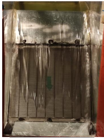
Figura 72. Comportamiento en laboratorio de los 6 caudales sobre la reja H4
