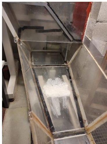
Figura 10. Tramo de reducción.
