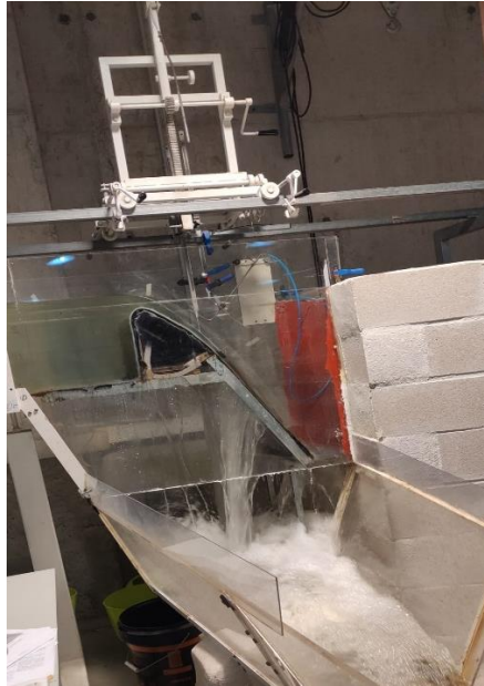
Figura 13. Estructura metálica de 60° con plato de aceleración y reja.
