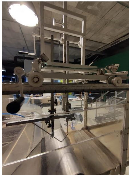
Figura 6. Carro móvil porta instrumentos
