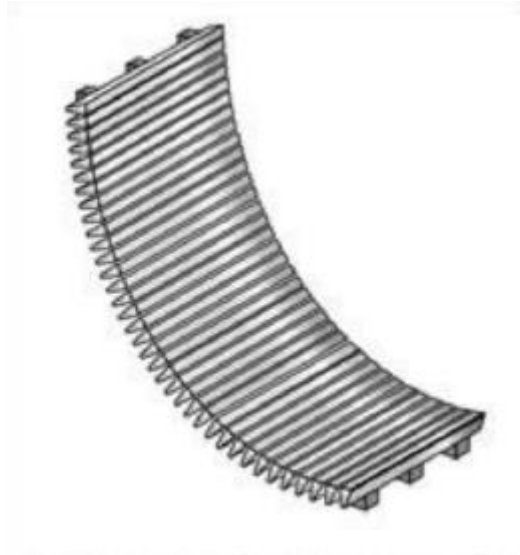
Figura 1. Pantalla efecto Coanda. (Fuente: Plastok, 2014)
