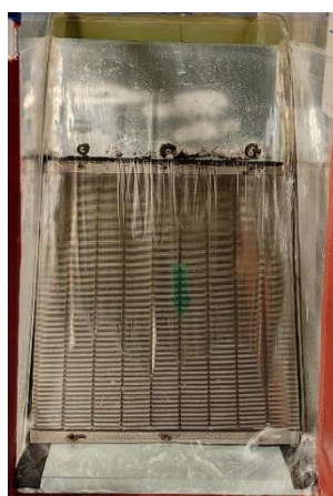
Figura 46. Comportamiento en laboratorio de los 6 caudales sobre la reja H2
