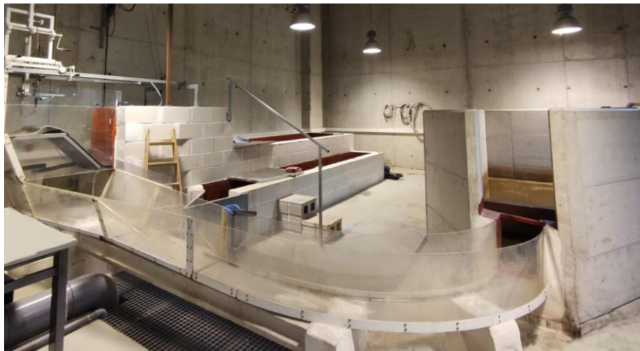
Figura 9. Canal de caudal captado, con tramo curvo y desarenador.
