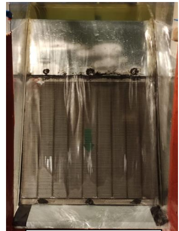
Figura 72. Comportamiento en laboratorio de los 6 caudales sobre la reja H4
