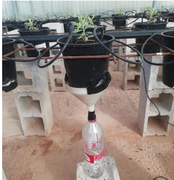
Fotografía 4. Sistema de recolección de drenaje (Pascual C., 2021).
