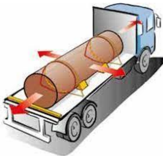
Imagen 5. Esquema de fuerzas actuantes en la cisterna cuando se encuentra en acto de servicio, es decir, en marcha
