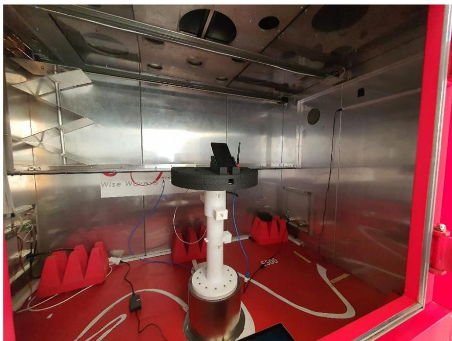
Figura 2.2.2 Interior cámara de reverberación E500
