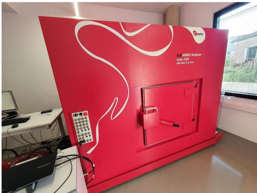
Figura 2.2.1 Exterior cámara de reverberación E500
