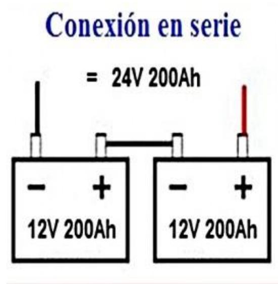
*Figura 2.7 :Conexión de dos batería en serio*
