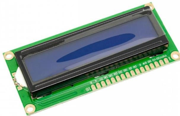
*Figura 3.17 : pantalla LCD 16x2*
