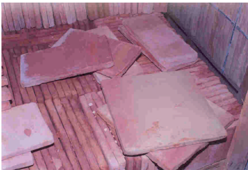
Figura 4. Loseta cerámica acabada
