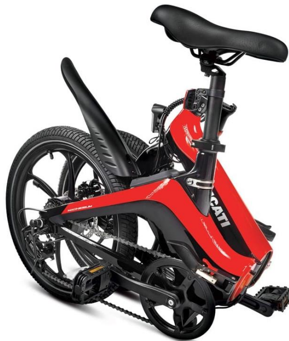
Figura 36. Bicicleta eléctrica MG-20 plegada.
