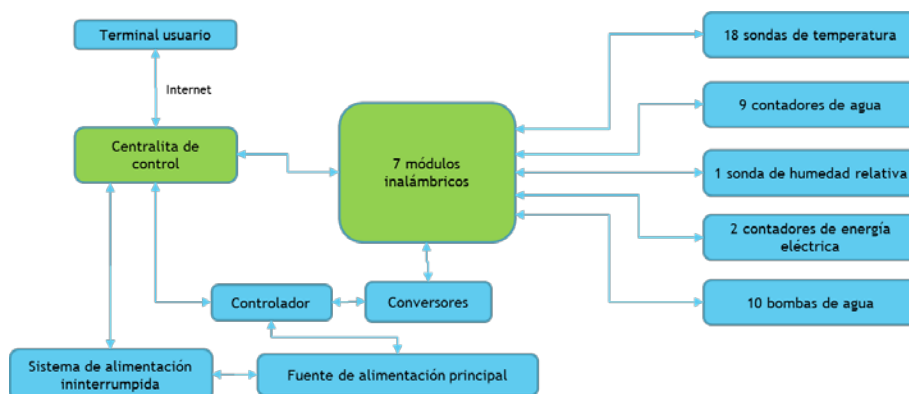
Figura 2: Diagrama de funcionamiento del sistema de instrumentación y control.
