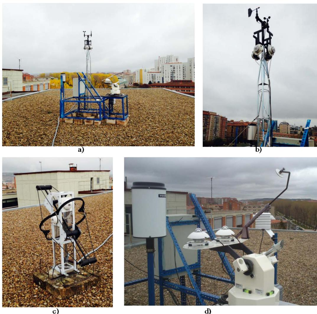
**Figura 2.** Relación de equipos de la estación SWIFT0001. a) Visión general de la estación. b) Torre de medición de radiación global sobre plano vertical, veleta y anemómetro. c) Torre de medición de irradiancia difusa mediante anillo lobular. d) Pluviómetros y seguidor con disco solar para la medida de irradiancia difusa sobre plano horizontal, irradiancia global horizontal e irradiancia directa con pirheliómetro.
