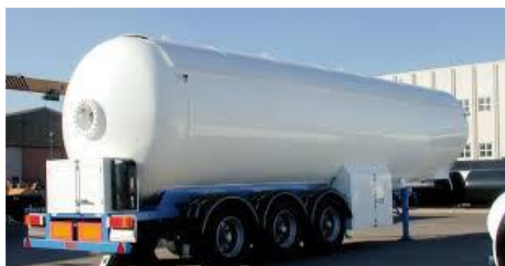
Ilustración 6. Ejemplo de cisterna con parasol
