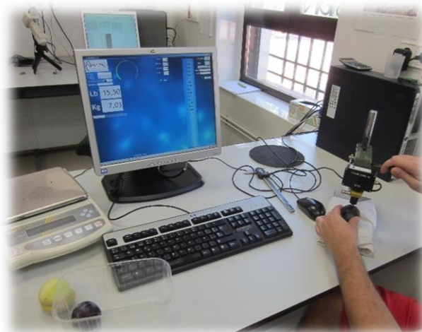
Fotografía 4-7. Penetrómetro Porxxon configurado en el equipo.
