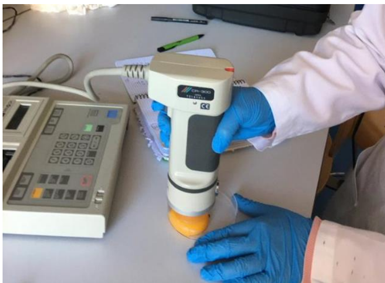
Ilustración 9: Colorímetro Minolta midiendo el color de la yema.
