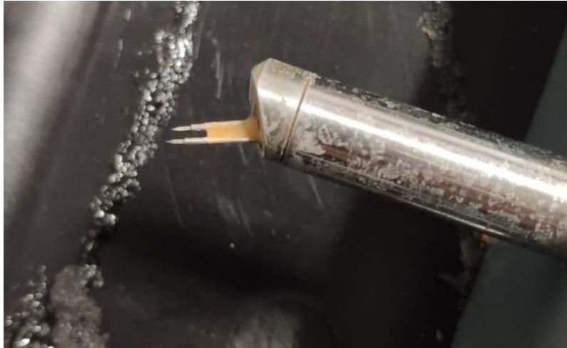
Figura 2.7 Sonda óptica de doble punta
