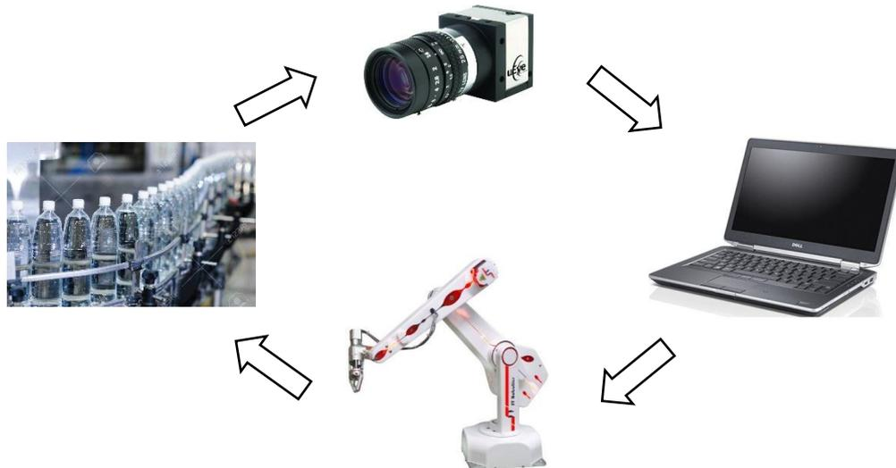
Figura 2.5 – Sistema de Visión por Computador
