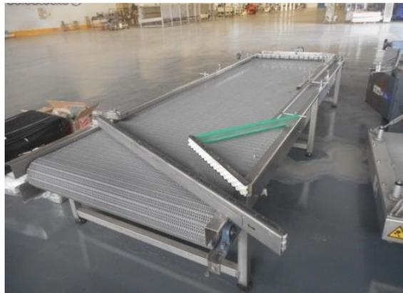
*Figura 4. Mesa simple de banda ancha* [2]
