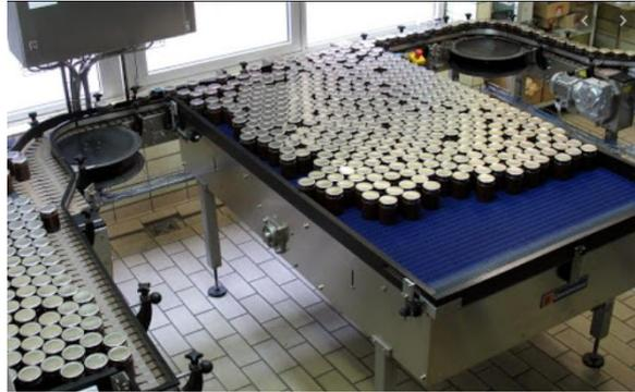
Figura 2. Pulmón normal con entrada y salida lineal [2]
