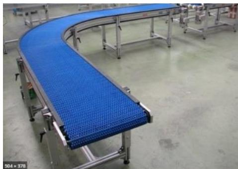
Figura 3. Transportador de banda modular [3]
