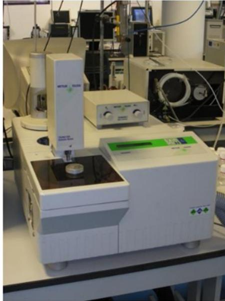
Figura 5. Equipo empleado para los ensayos de “Calorimetría diferencial de barrido”.
