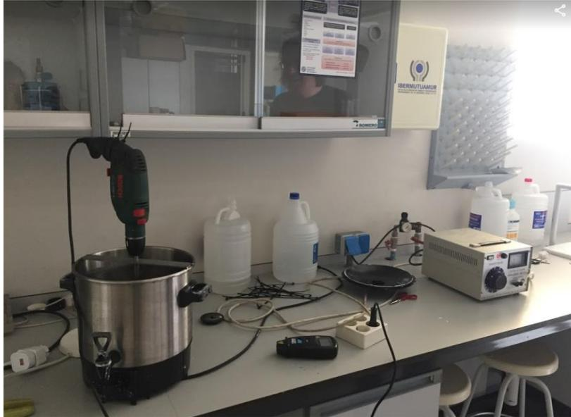
Figura 22. Lugar de trabajo para el estudio del efecto del rascado sobre la Parafina RT47.
