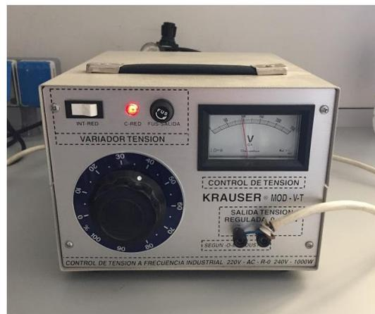
Figura 21. Variador de tensión alterna finalmente empleado en los ensayos de degradación. Proporcionado por el departamento de Electrónica de la Universidad Politécnica de Cartagena.
