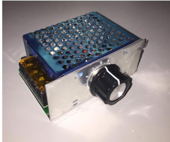
Figura 20. Primer variador de tensión alterna empleado en los ensayos de degradación. Comprado por el departamento de Ingeniería de Mecánica de Fluidos de la Universidad Politécnica de Cartagena.
