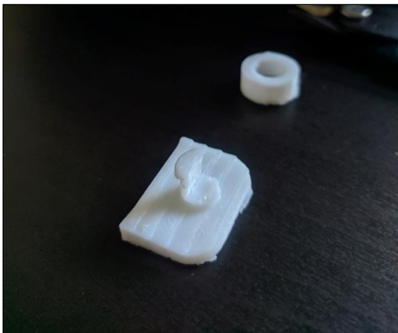
Figura 3.5 Rotura de las piezas de la unión entre Fixed Gauntlet y Rotating Gauntlet 1
