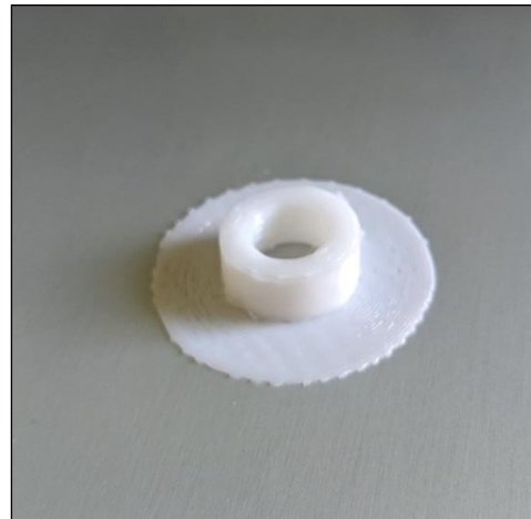
Figura 3.4 Piezas impresas para la comprobación de la unión de las piezas Fixed Gauntlet y Rotating Gauntlet 2
