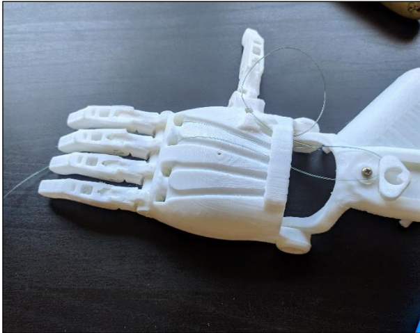
Figura 3.26 Montaje de los cables tensores 1
