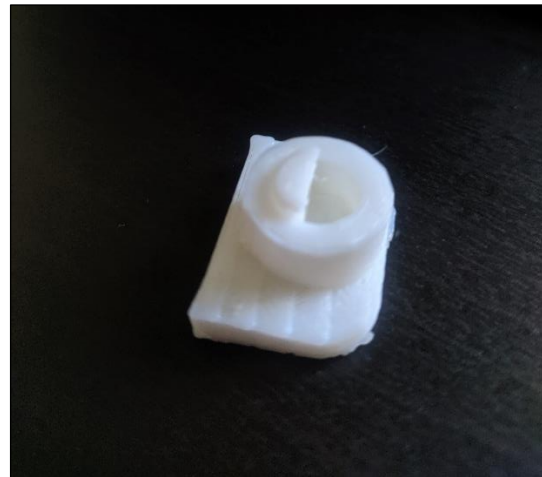
Figura 3.6 Rotura de las piezas de la unión entre Fixed Gauntlet y Rotating Gauntlet 2
