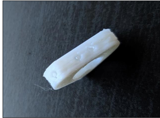
Figura 3.21 Pieza mal impresa del tensor 2
