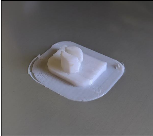
Figura 3.3 Piezas impresas para la comprobación de la unión de las piezas Fixed Gauntlet y Rotating Gauntlet 1
