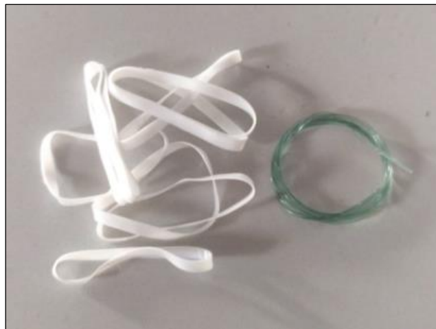
Figura 3.25 Elásticos y cables usados para la prótesis (cable elástico a la izquierda y cable tensor a la derecha)
