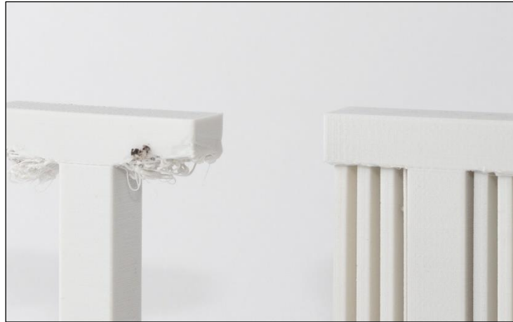
Figura 2.30 Comparativa de la impresión de una T con soporte y sin él [59]
