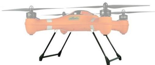
Ilustración 11. Tren de aterrizaje de un dron
