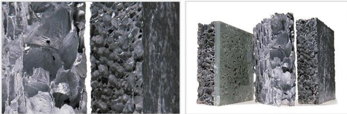
Ilustración 24. Espuma metálica
