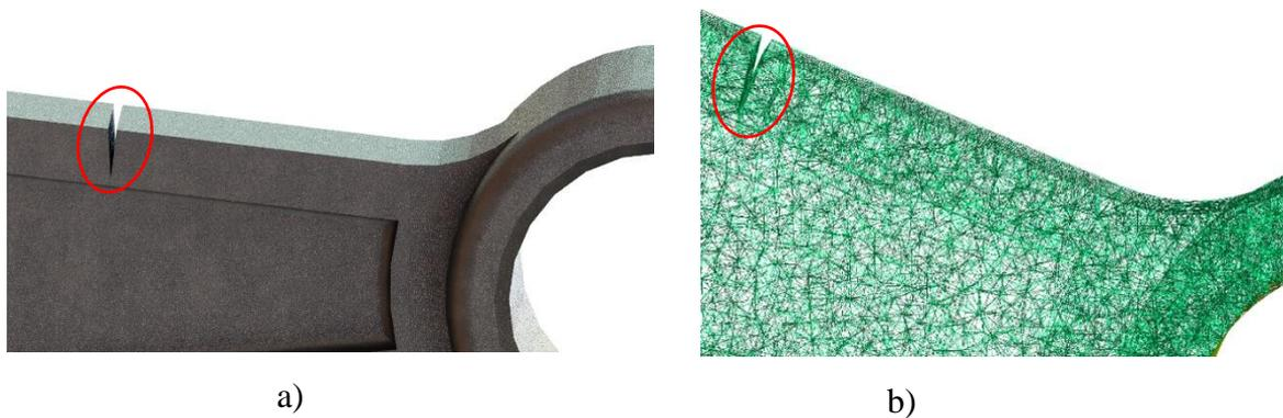
Figura 7. 36. Defecto inicial de la biela a) y su mallado b)
