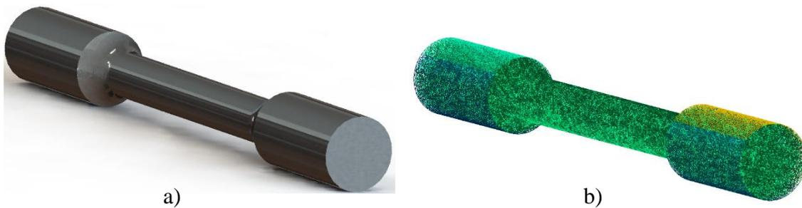
Figura 7. 29. Vista tridimensional a) y malla b) de la probeta
