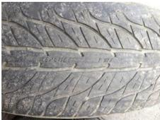
Fig. 3: Un neumático que indica cuándo hay que cambiarlo.
