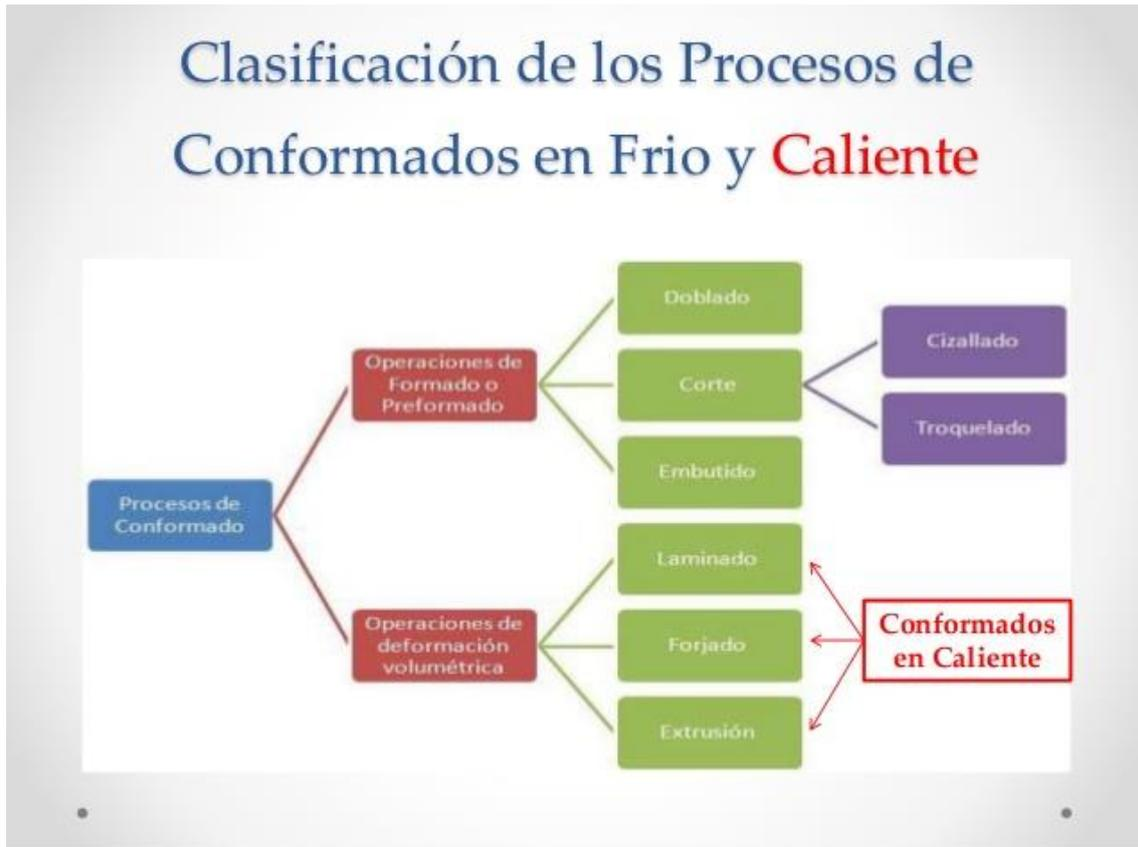
Fig.8: Procesos de conformado. Fundamental concepts of metal forming technology. Fuente: <https://www.slideshare.net/cruzbermudez/presentacin-conformado-en-caliente> [Pág. 6]
