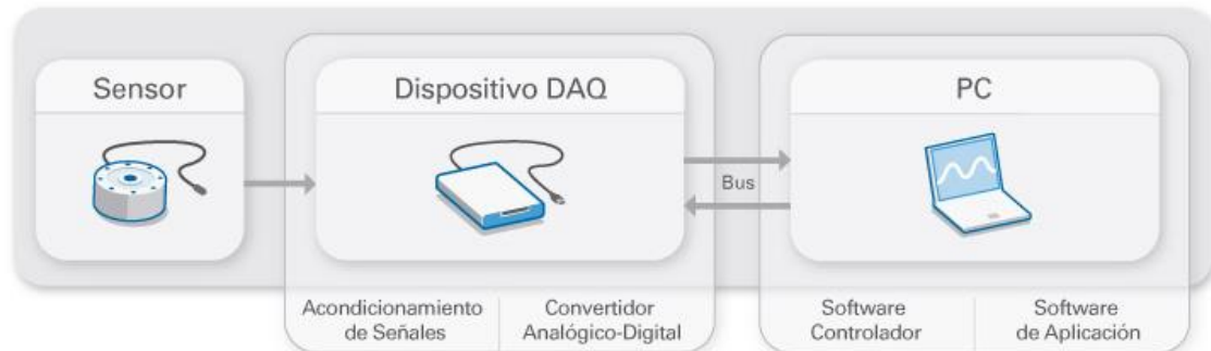
Figura 24: Partes de un Sistema DAQ
