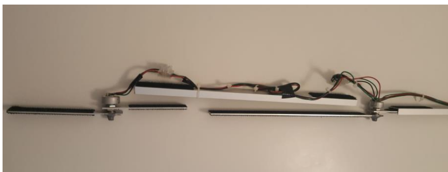
Figura 27: Unión entre dos articulaciones
