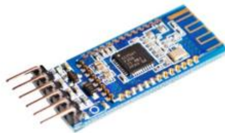
Figura 4.15: módulo Bluetooth BLE HM-10
