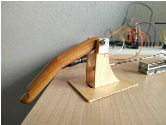
Figura 5.1: actuador lineal basado en dispositivo protésico. Fabricado de madera con una base para generar estabilidad
