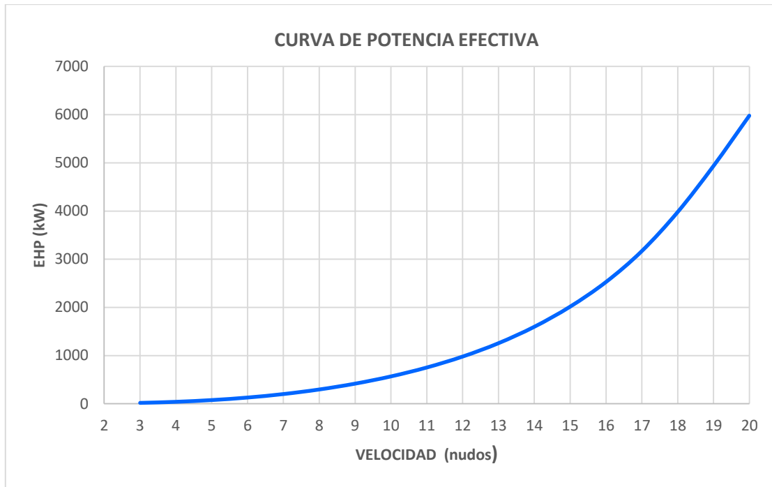
Gráfico 5.2. Potencia efectiva en función de la velocidad
