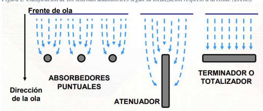
Figura 3. Clasificación de los sistemas undimotrices según tamaño y orientación. (Ereño).
