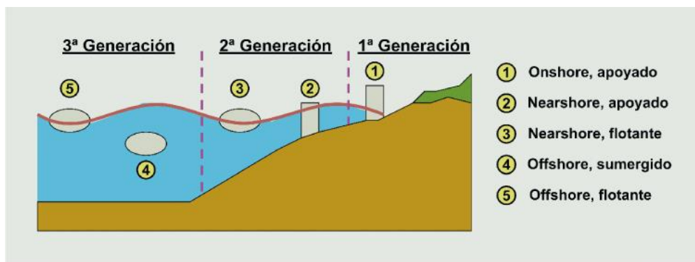
Figura 2. Clasificación de los sistemas undimotrices según su localización respecto a la costa. (Ereño).
