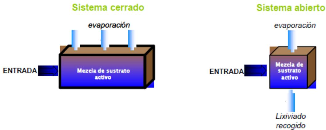
Figura 11. Esquema representativo del sistema cerrado y abierto.
