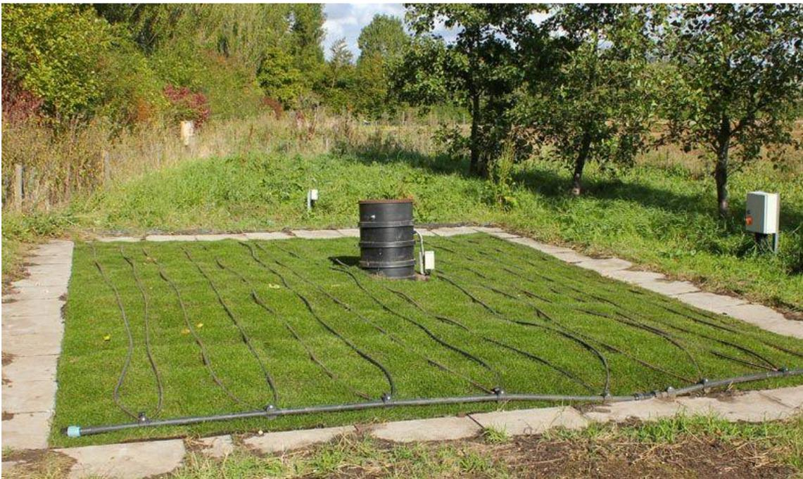
*Figura 10. Distribución del agua a tratar en la superficie de un biobed utilizando mangueras de riego por goteo.*
