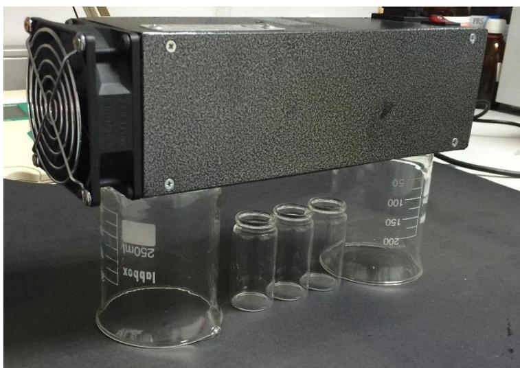
Ilustración 4.7. Montaje de la lámpara con los frascos de cristal con Metilparabeno.
