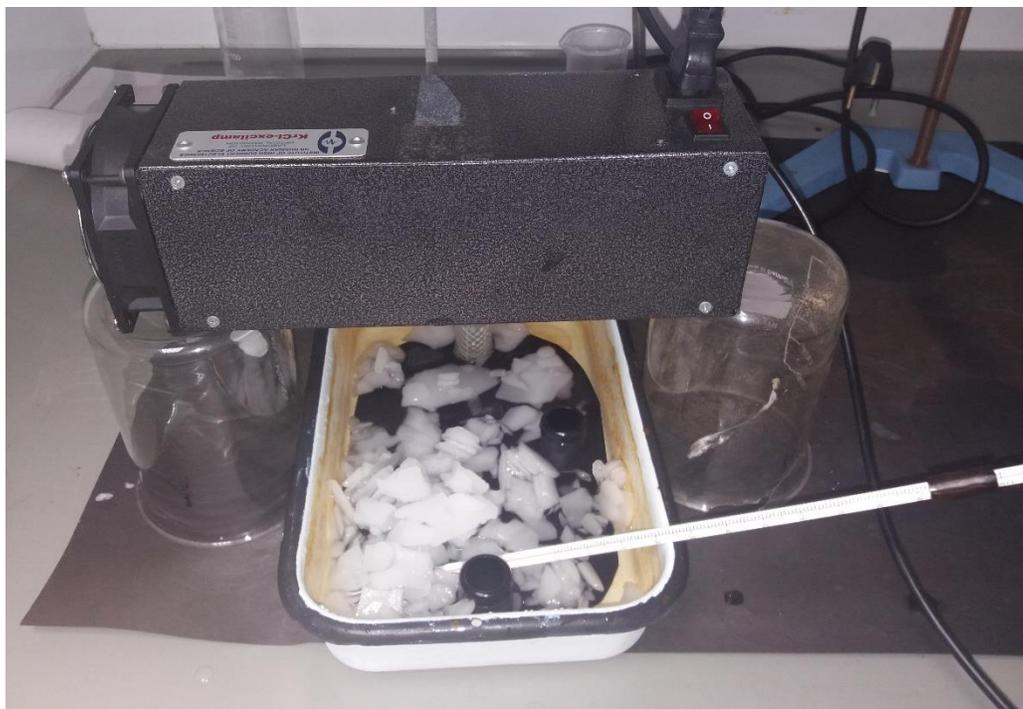
Ilustración 5.1. Montaje del Ensayo 5 con hielo y termómetro.
