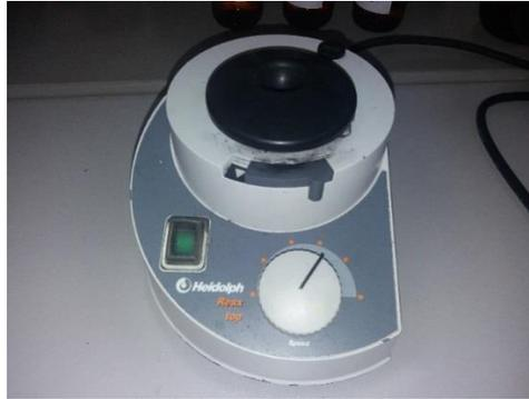
Ilustración 4.9. Agitador de tubos de ensayo.
