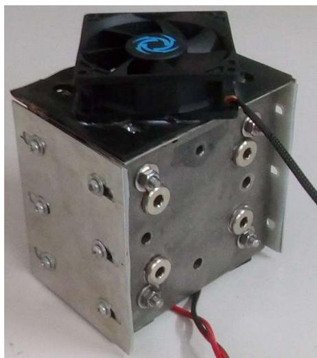
Figura 3.11. Celda de combustible hidrógeno/aire.
