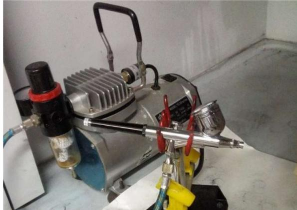
Figura 3.5. Aerógrafo y compresor.
