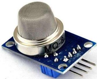
Figura 6.3. Sensor de concentración de hidrógeno.
