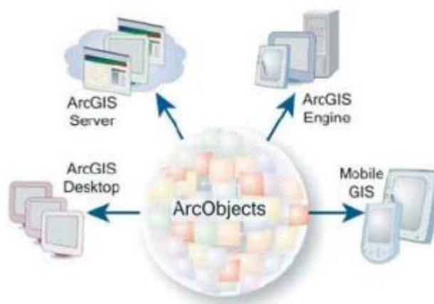
Figura 2.1. ArcObjets es una librería común para los cuatro componentes ArcGIS [5].
