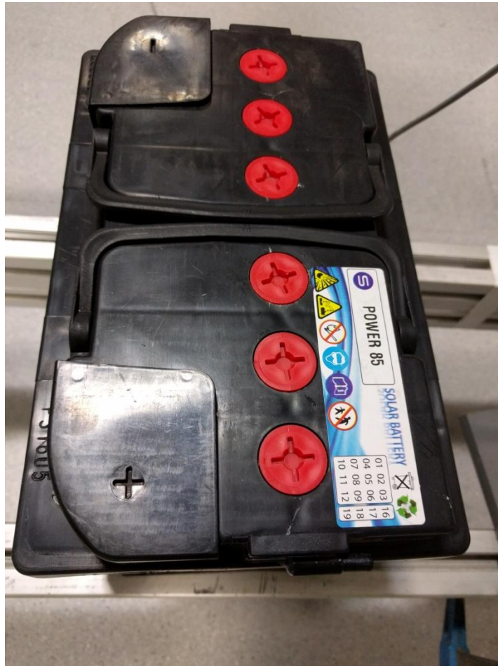
Figura 57: Batería para pruebas de la instalación
