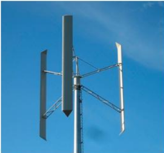
Figura 7: Ejemplos de aeroturbinas Darrieus tipo H. A la izquierda, de álabes fijos, a la derecha, de álabes móviles, también conocida como Cycloturbine.
