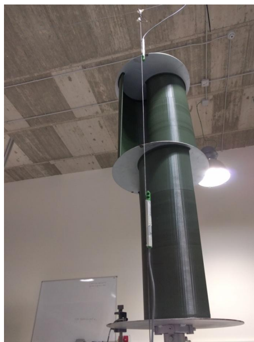
Figura 71: Disposición de anemómetros en cable vertical
