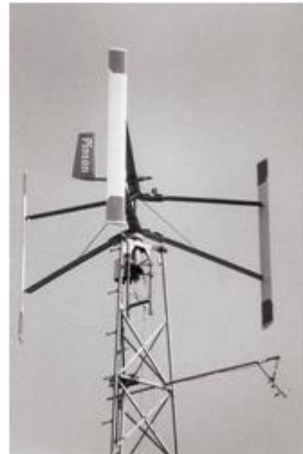
Figura 7: Ejemplos de aeroturbinas Darrieus tipo H. A la izquierda, de álabes fijos, a la derecha, de álabes móviles, también conocida como Cycloturbine.
