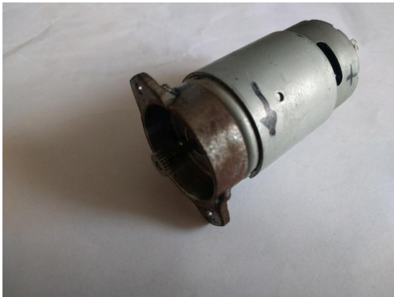
Figura 54: Detalle de la dinamo utilizada. Se puede apreciar el casquillo utilizado para su adaptación al sistema de transmisión mecánica.
