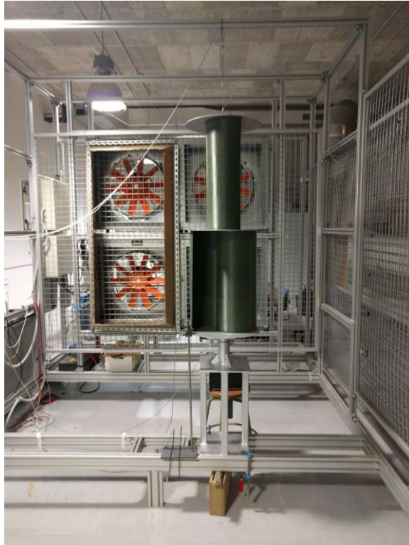
Figura 83: Disposición de la turbina frente a la columna derecha de ventiladores. Se desplazó a la derecha con el objetivo de realizar el ensayo a más velocidad que en los ensayos con tobera
