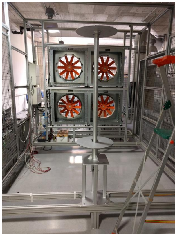
Figura 68: Montaje de la estructura del rotor en el banco de ensayos
