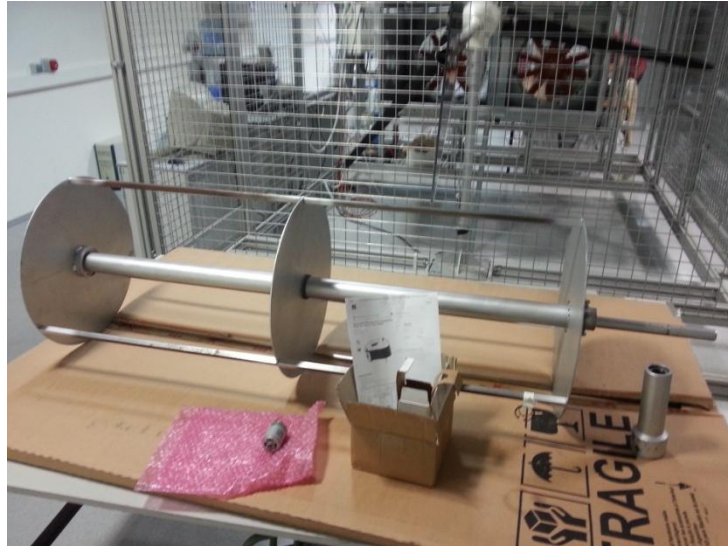
Figura 52: Cuerpo del rotor junto a elementos de transmisión y generación. Se unieron perfiles a los discos del rotor para mantener la geometría durante su fabricación.
