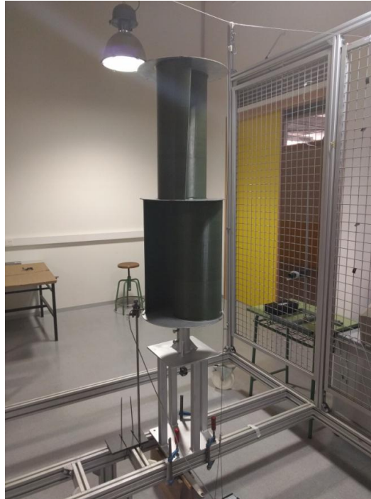
Figura 70: Centrado de la aeroturbina respecto a columna de ventiladores
