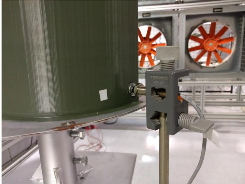
Figura 72: Detalle de la colocación del captador de pulsos, la arandela y la banda para el tacómetro óptico
