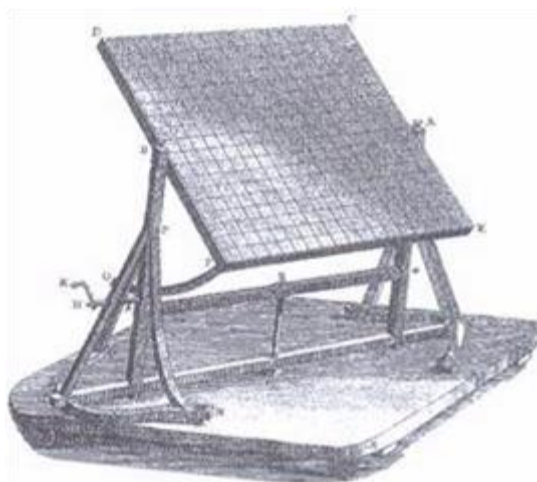
Figura 18: Mecanismo con 168 piezas de cristal diseñado por Buffon. Fuente: recuerdosdepandora.com
