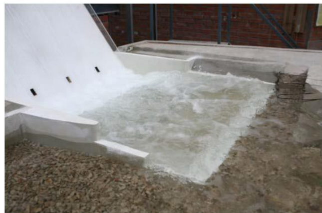
Figura 5.2 Prototipo de la presa de Buendía. Cedex. (Fuente: ALONSO Y MORENO [2])
