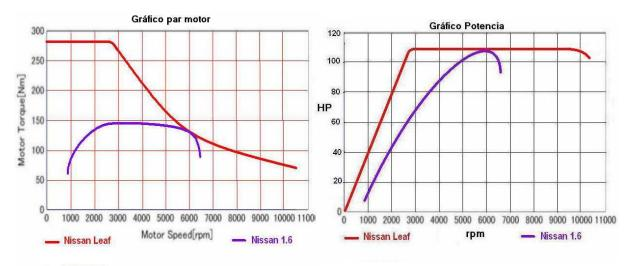
Imagen 22: Comparativa de par y potencia de vehículo eléctrico y combustión. Fuente: Nissan.
