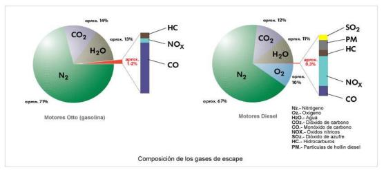
Imagen 4: Composición de los gases de escape de los vehículos de combustión. Fuente: aficionadosalamecanica.net.
