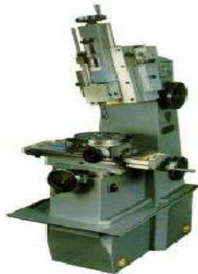
**Figura 2.11:** Esquema de una mortajadora y fotografía de una máquina real.
