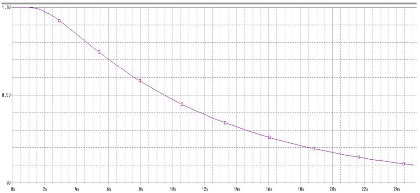
Figura 4.19 Evolución temporal del exceso de presión intersticial en la celda del extremo inferior derecho. Caso 21  $C_{vx} = 0,10$ .
