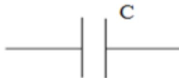
Figura 4.2 Representación simbólica de un condensador lineal.
