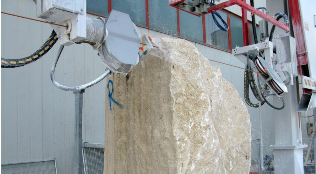
Ilustración 8. Máquina de corte con hilo diamantado. Recuperado de www.directindustry.es .
