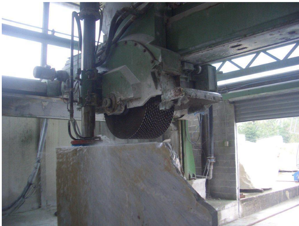
Ilustración 9. Cortabloques de mármol. Recuperado de http://www.amsgroupnet.com .
