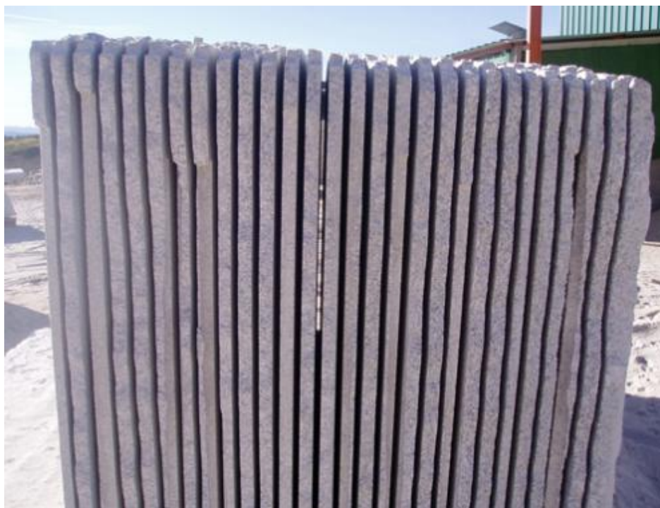
Ilustración 7. Placas resultantes del corte mediante telar. Recuperado de http://www.sogestone.com .
