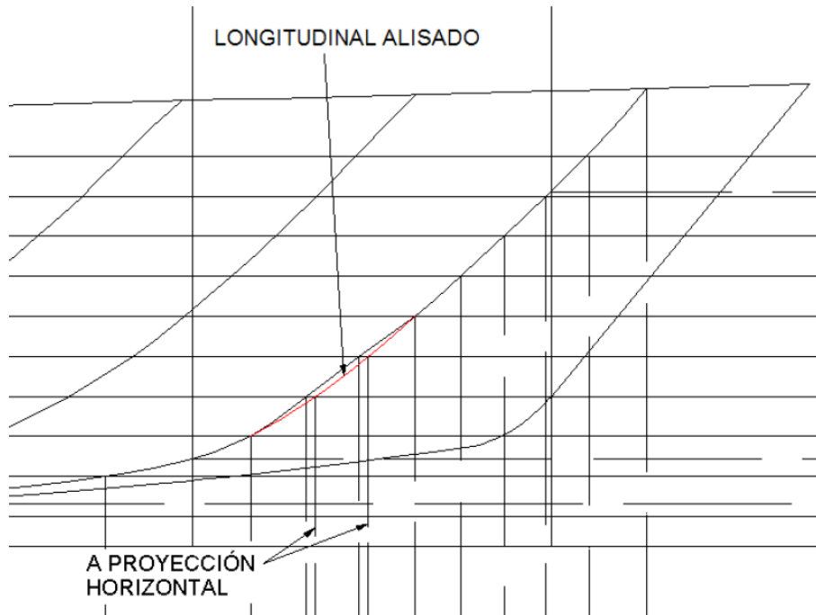
Figura III.15. – Alisado del longitudinal.
