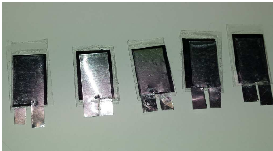
Figura 25: fotografía de algunos sensores ya montados antes de ser cableados e insertados en la plantilla.
