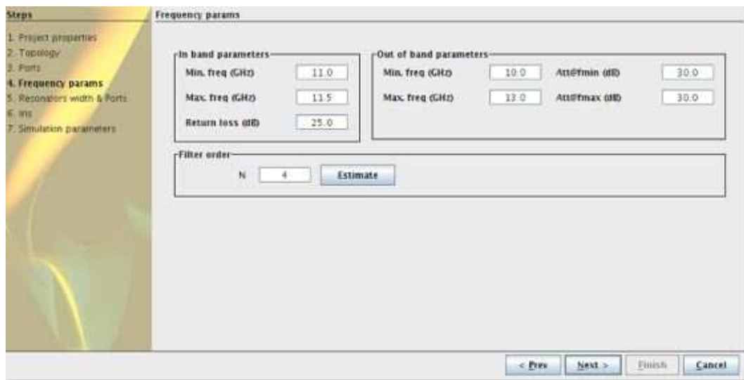
Figura 2.46: Ventana para introducir los Parámetros de la Frecuencia.
