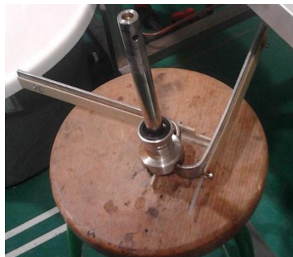
Figura 20: Estado del rascador con una reductora inadecuada
