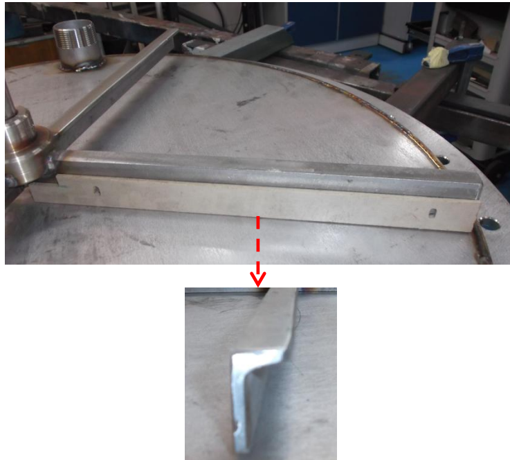
Figura 62: Nuevo diseño de las aspas del rascador
