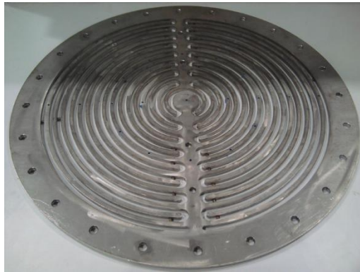
Figura 12: Placa canalizada que constituyó el serpentina del evaporador
