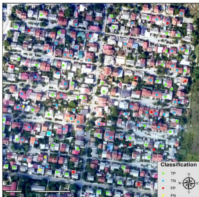
Ilustración 15. Resultados de la clasificación de techos con amianto. TP-Verdadero positivo; TN-Verdadero negativo; FP-Falso positivo; FN-Falso negativo. Los resultados pronosticados falsamente se debieron a la baja visibilidades del techo por elementos ajenos al mismo como edificios más altos o árboles. Fuente: Kaplan et al. (2023).
