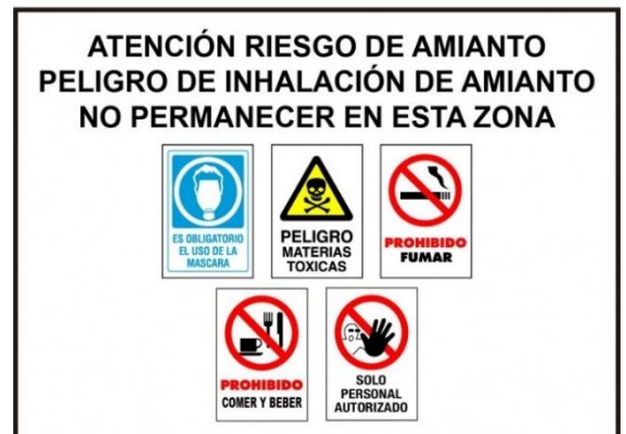
Ilustración 16. Señalización temporal de presencia de amianto en una obra. Fuente: Pastor, P. (2021).
