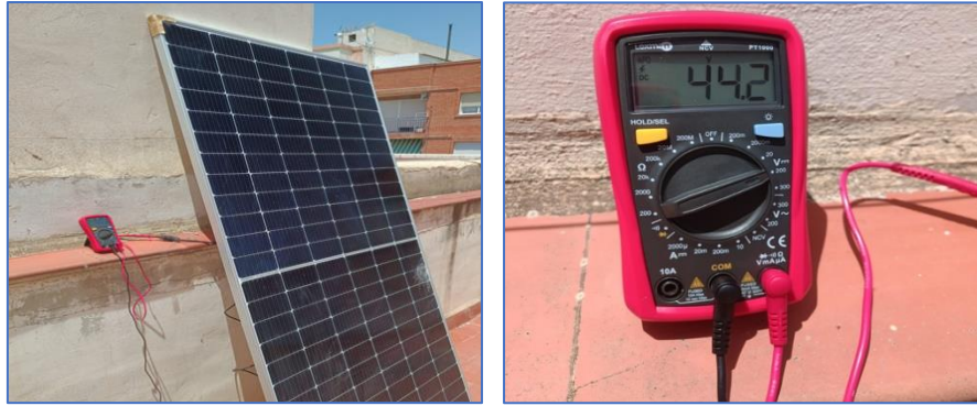
Figura 69. Medición de voltaje (marco sin pintar) hora de medición 14:37
