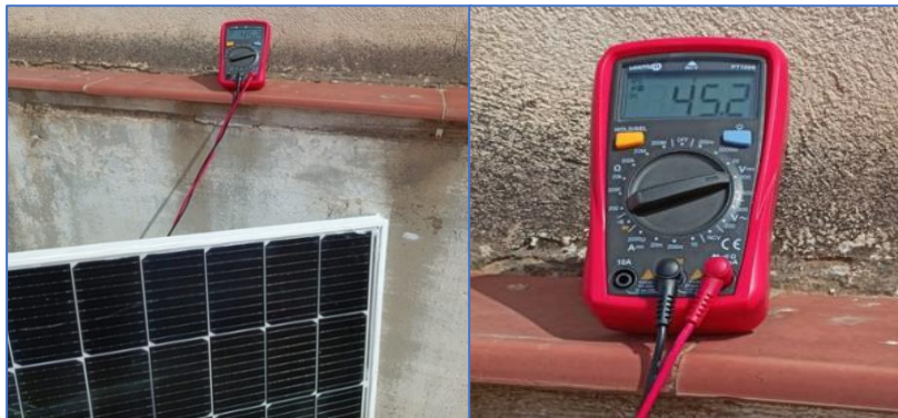
Figura 71. Medición de voltaje (marco sin pintar) hora de medición 17:40
