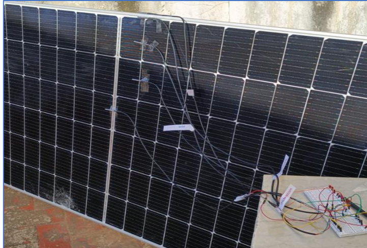
Figura 59. Medición de temperaturas para el modelado del cálculo basado en nodos
