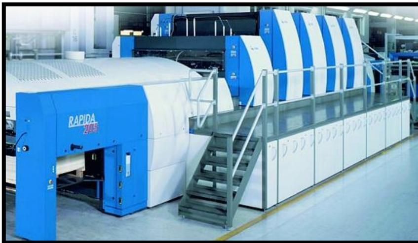
*Ilustración 16: Línea de Litografía con 4 Cuerpos. Fuente: Interempresas.*
